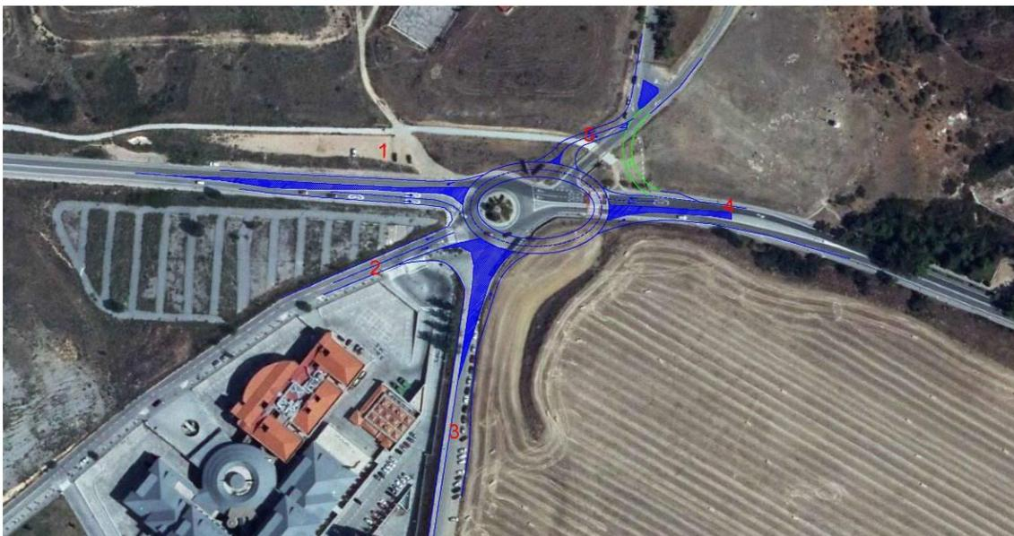
Ilustración 54. Esquema preliminar de nueva glorieta, base para estimar los requerimientos de suelo para la ejecución del nuevo acceso.
